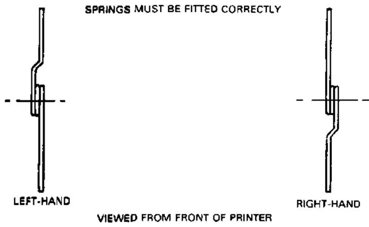
FIGURE 5 PINCH ROLLER SPRINGS
