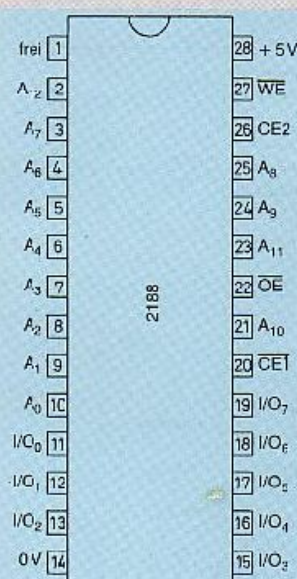
Anschlussschema des RAM-Typ 2188 mit 8192 x 8
