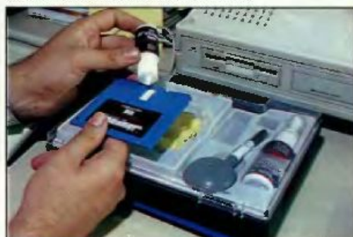
El disco-limpiador se rola con la solución no abrasiva que permite limpiar las cabezas sin desgastarlas.
