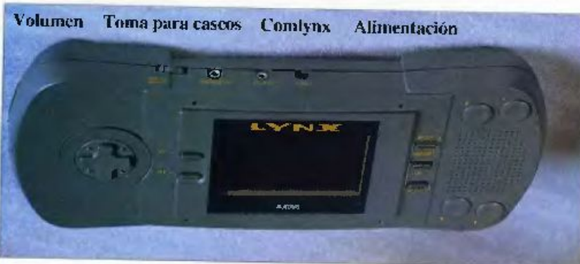
Conexiones de la consola ATARI LYNX
