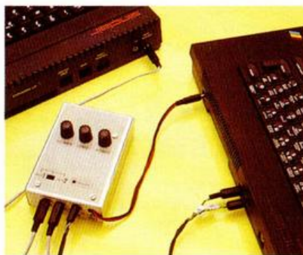
Ejemplo de interconexión entre Spectrum Plus y Spectrum Plus 3.
