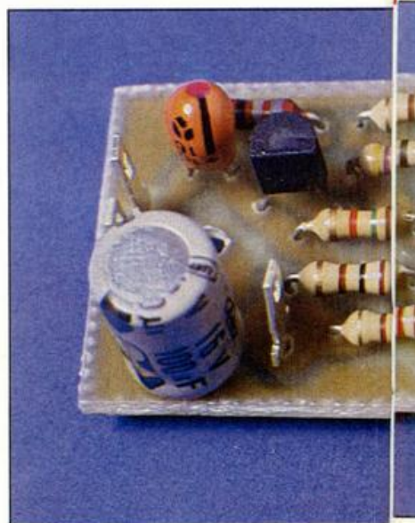
Aspecto final de la tarjeta una vez montada la totalidad de los componentes.
