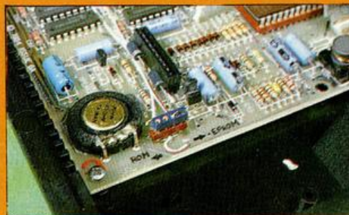
ROM y EPROM son intercambiables a voluntad gracias al zócalo colocado en el antiguo emplazamiento de la ROM.
