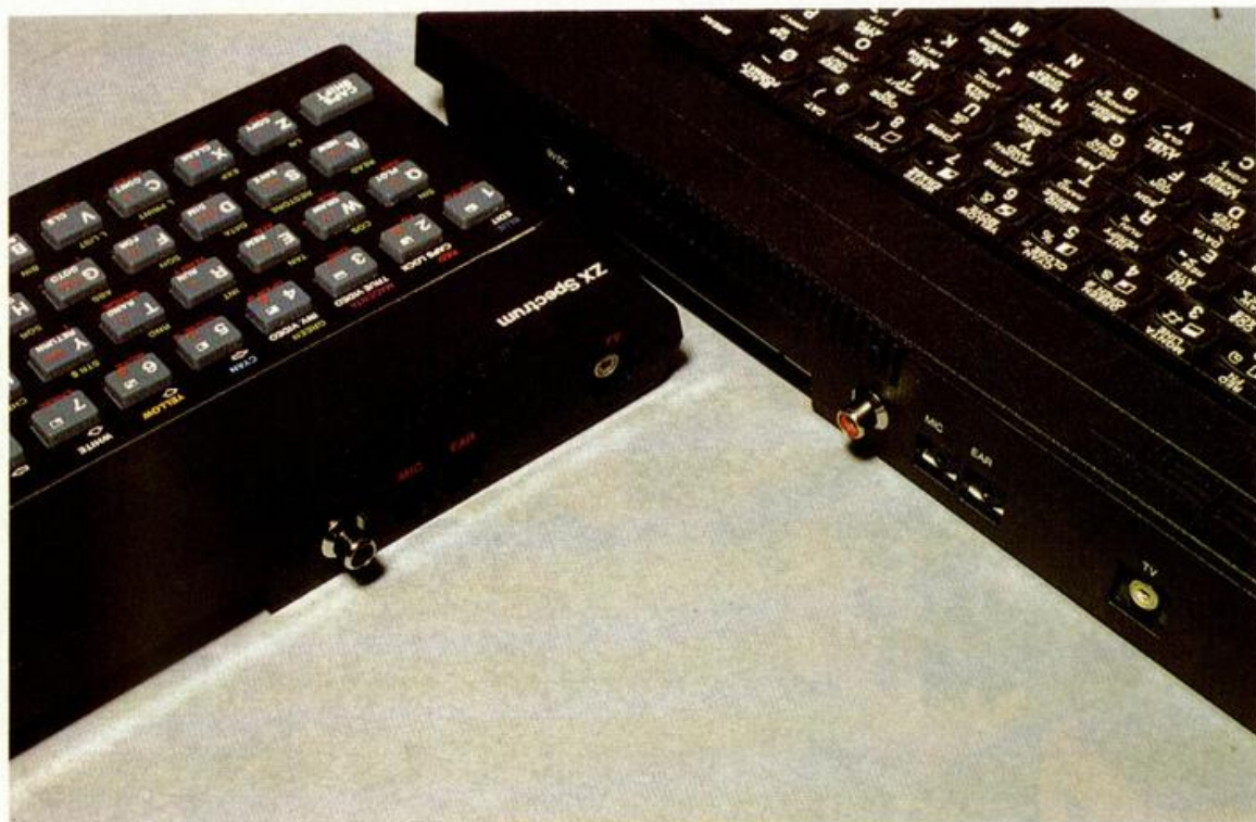
Aspecto final de las salidas de video en el Spectrum 48 K y en el Spectrum Plus. Los resultados no afectan negativamente a la estética de ambos microordenadores.
