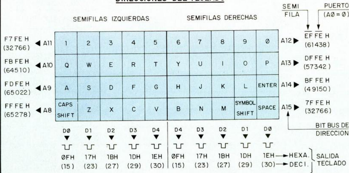
El teclado: Direcciones de sus semifilas y salidas de sus columnas hacia el bus de datos. (Fig. 4).
