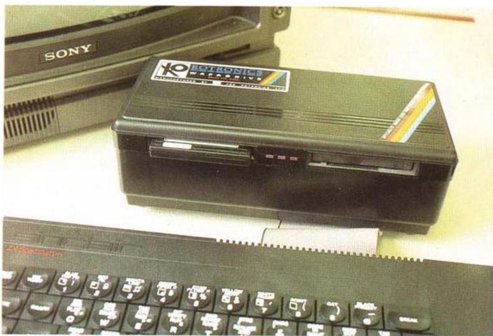
Aspecto de la parte frontal. De acuerdo con un diseño muy sencillo, su única conexión con el Spectrum es un cable plano de unos 9 cm.
