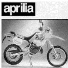
**MOTOR:** Monocilíndrico, 2 tiempos, con contraeje equilibrador, refrigerador por líquido.
