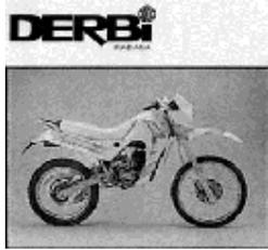
**MOTOR:** Monocilíndrico de dos tiempos, cilindro de aluminio con recubrimiento interior de Níquel y Carburos de Sicilio "Scanimet" de vida ilimitada.
