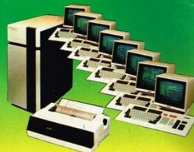
9 HAYAC-3900 MULTITERMINAL, MULTIPROCESO, TIEMPO REAL 20, 40, 74 MB por Hard Disk. Compilador COBOL. Generador paramétrico. 1 MB de memorias. Hasta 8 procesos en tiempo real. 16 terminales.
