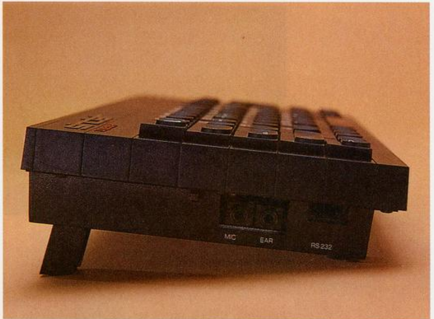
En el lateral izquierdo de la carcasa han sido instalados los conectores del casete EAR, MIC y el de impresora RS 232.
