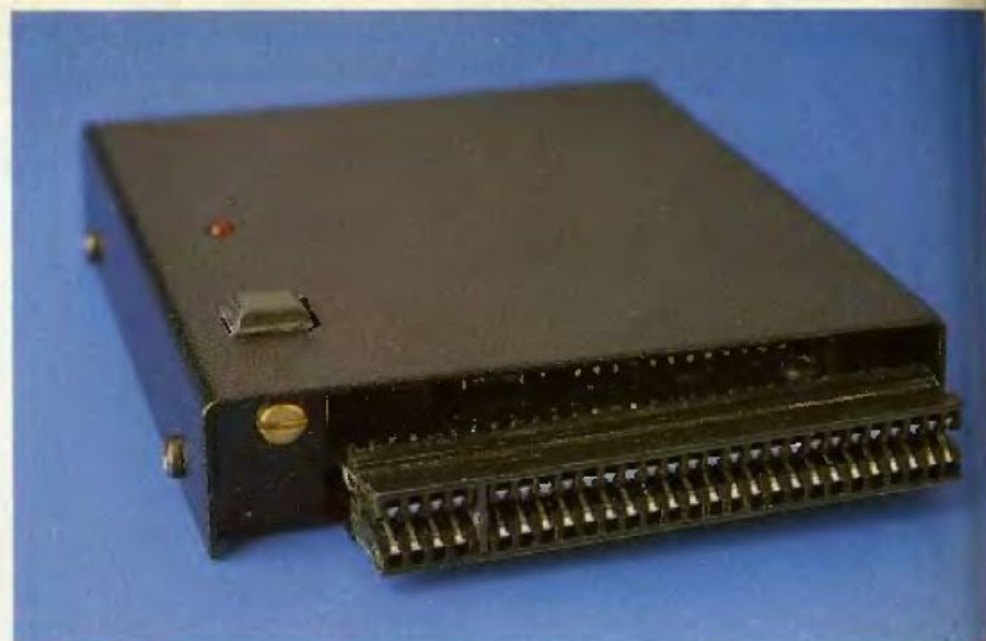
En la parte superior del PLUS D podemos observar el snap-button.
