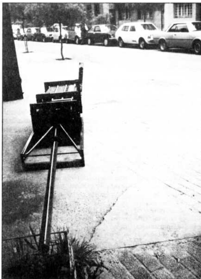
Foto 2: Con la Enfardadora Simplex es posible obtener fardos de hasta 20 kgs. de peso y de dimensiones normales (42 x 43 x 100 cm.).
