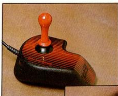
Los microswitches interiores aseguran más de un millón de usos.
